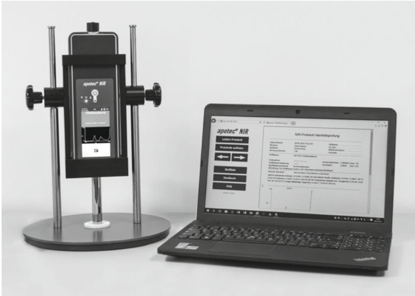
◉ **Abb. 1.3** NIR-Spektroskop zur Prüfung von Ausgangsstoffen
