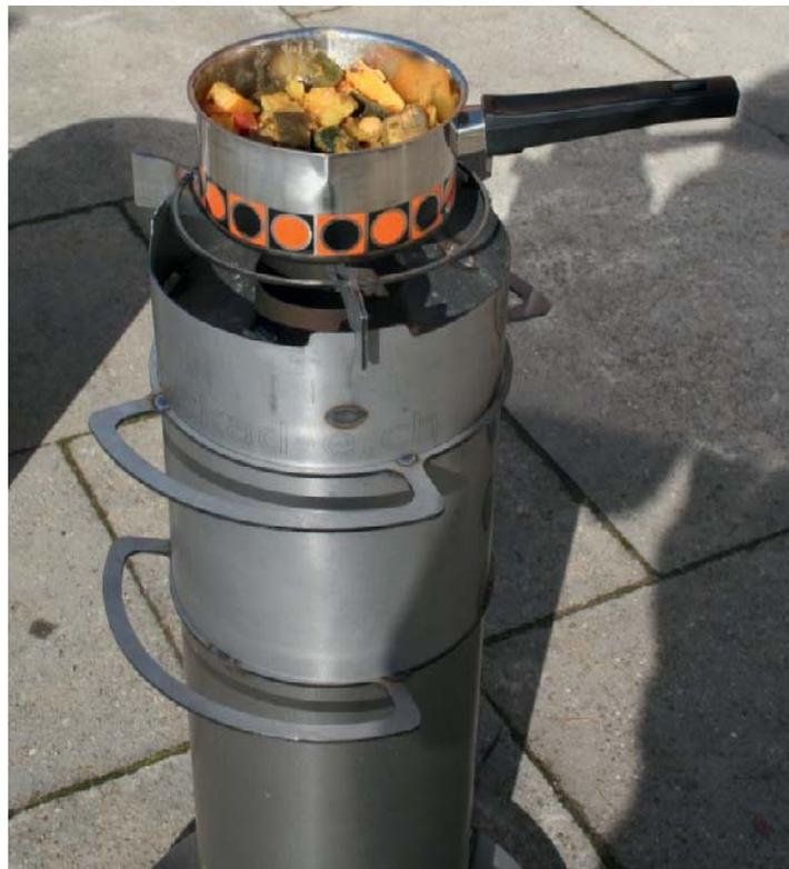
Abbildung 2 Angepasste Technologie von klein bis gross: – trocken bis feucht: Der kleine Pyro-Cook von Kaskad-E in Basel, entwickelt für Haiti: er erzeugt aus trockenem Gartenschnitt Kohle und ein rauchfreies Kochfeuer:
