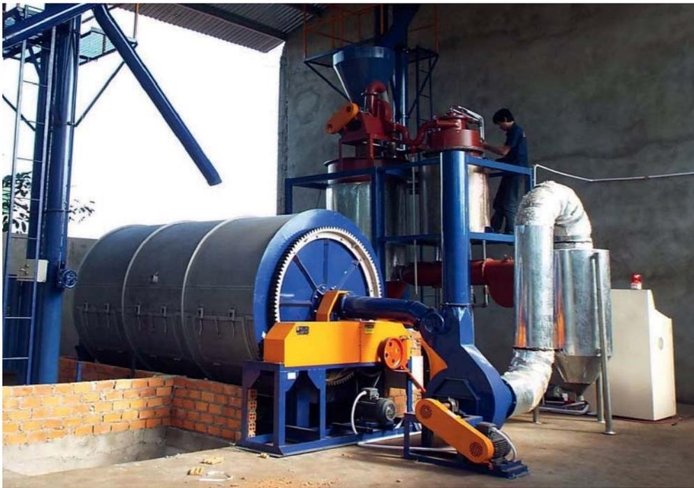
**Abbildung 3** Die PPV300 Anlage (rechts) – das in Vietnam nachgebaute Gerät des Ökozent-rums: aus feuchter Kaffeepulpe wird Kohle und Kaliumdünger (total 33 kg/h) erzeugt und gleichzeitig 150 Kilowatt Heizleistung geliefert für den Trockner mit einem Inhalt von vier Tonnen Rohkaffee.
