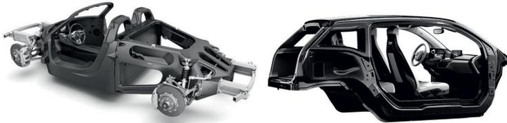
*Bild 2.2: Anwendung von kohlenstoffaserverstärktem Kunststoff im Automobilbau
