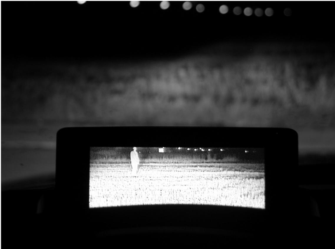
Bild 2.1 : NightVision-System im Fahrzeug
