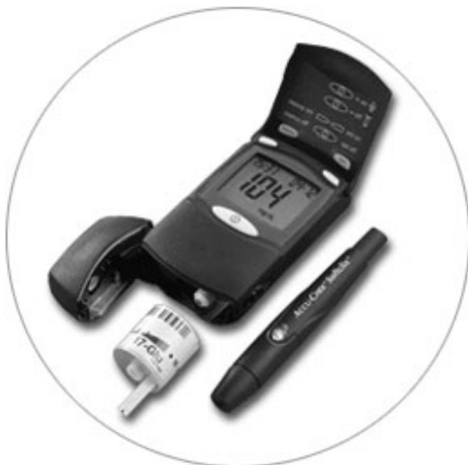
**Abb. 1.1:** Kommerziell erhältliches Blutzucker-Messgerät ACCU-CHEK® Compact von Roche Diagnostics<sup>1</sup>, wie es von Diabetikern zur punktuellen Bestimmung der Glucosekonzentration im Blut verwendet wird. Die Stechhilfe rechts unten dient zur Gewinnung einer kleinen Menge an Kapillarblut aus dem Finger, die Trommel daneben enthält die Messstreifen mit Glucoseoxidase zur enzymatischen Reaktion mit Glucose.
