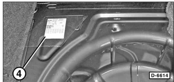
4 – Auf dem Fahrzeugdatenträger, der auf dem Kofferraumboden aufgeklebt ist.
