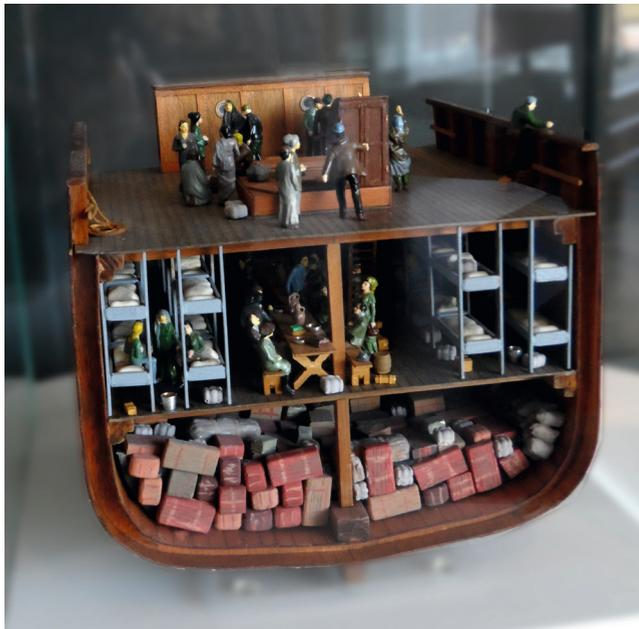
*Abb. 1: Querschnitt eines Auswandererschiffes*
