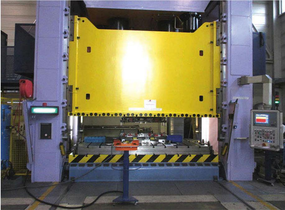
**Bild 3-3:** Presse mit Lichtvorhang (Quelle: Fa. Scherdel Marienberg GmbH/Verfasser)
