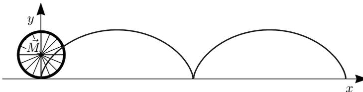
Abb. 2.6: Abrollkurve, die beim Abrollen eines Rads entlang einer Geraden entsteht.
