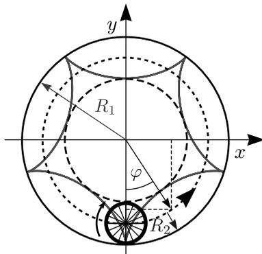
Abb. 2.7: Abrollen eines Rads auf dem Inneren eines Kreises.
