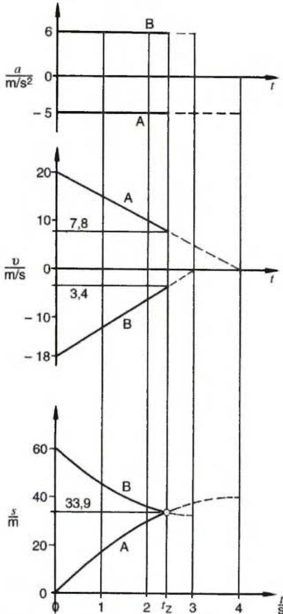
Abb. 2-9:  $s(t)$ ;  $v(t)$ ;  $a(t)$ -Diagramme für PKWs auf Kollisionskurs
