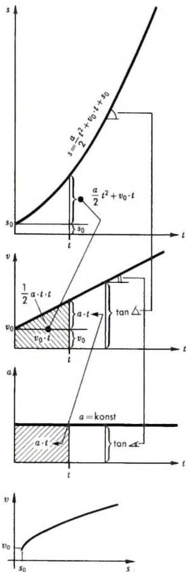
**Abb. 2-6:**  $s(t)$ ;  $v(t)$ ;  $a(t)$ ;  $v(s)$ -Diagramme für gleichförmig beschleunigte Bewegung
