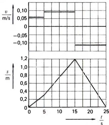
**Abb. 2-5:  $s(t)$ ;  $v(t)$ -Diagramme für Bewegung mit unterschiedlichen Phasen**
