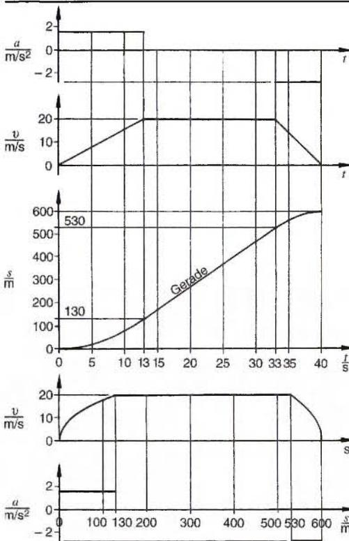
**Abb. 2-7:** Fahrdiagramme für Bewegung mit  $a = \text{konst.}$  in mehreren Phasen
