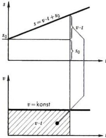
Abb. 2-3:  $s(t)$ ;  $v(t)$ -Diagramme einer Bewegung mit konstanter Geschwindigkeit
