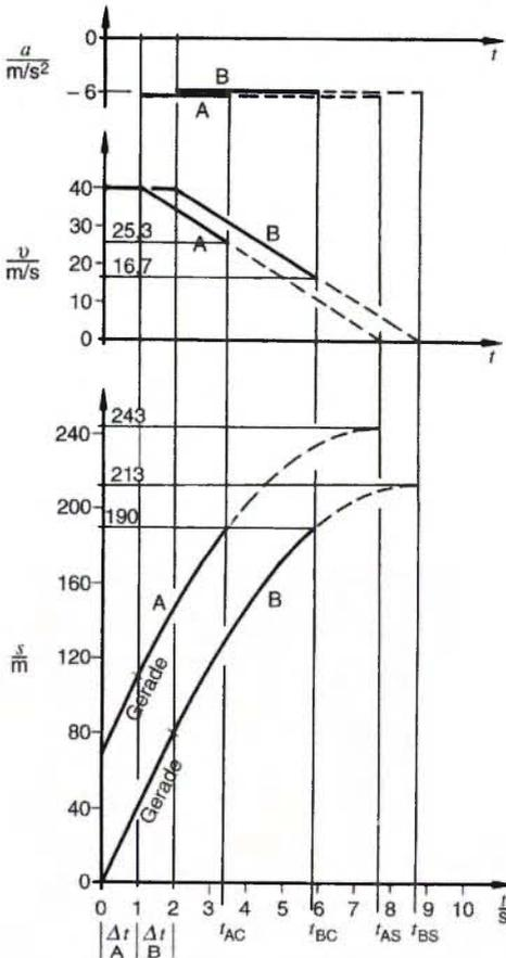
Abb. 2-11:  $s(t)$ ;  $v(t)$ ;  $a(t)$ -Diagramme für Auffahrnfall nach Beispiel 3
