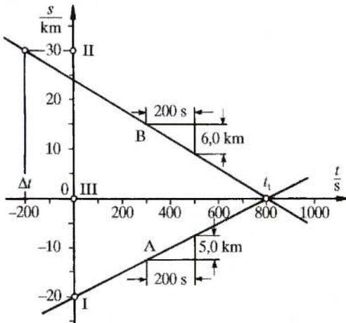
Abb. 2-4b: Das  $s(t)$ -Diagramm für die Bewegung der Züge von Beispiel 1
