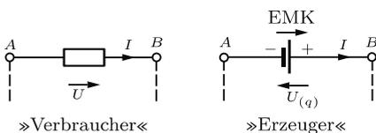
**Bild 1.6** Richtung von Strom und Spannung bei Verbrauchern und Erzeugern.
