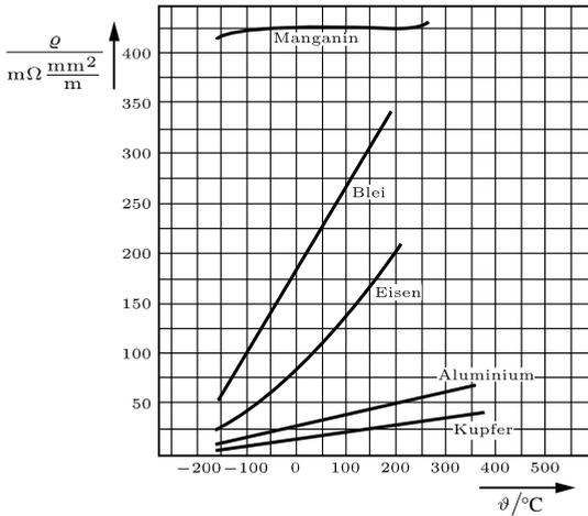
**Bild 2.3** Temperaturabhängigkeit spezifischer Widerstände.
