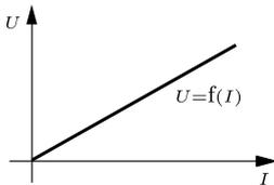
**Bild 2.2** Kennlinie  $U = f(I)$  eines ohmschen Widerstandes.
