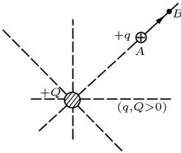
**Bild 1.5** Zur Änderung der potentiellen Energie beim Verschieben der Ladung  $q$  von  $A$  nach  $B$ .
