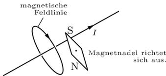
**Bild 1.3** Magnetische Wirkung des elektrischen Stromes.
