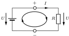
**Bild 2.1** Stromkreis aus Batterie und Widerstand.
