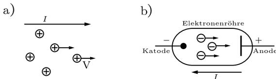
**Bild 1.2** a) Konventionelle Stromrichtung; b) Bewegungsrichtung der Elektronen in einer Elektronenröhre.
