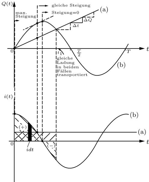
**Bild 1.1** Zusammenhang zwischen transportierter Ladung und Stromstärke.
