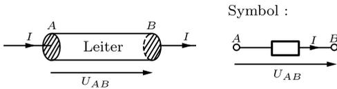
**Bild 1.7** Zur Definition des Widerstandes  $R_{AB}$ .
