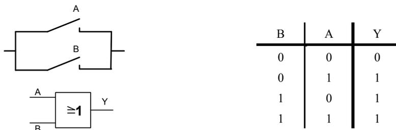
Bild 3.4: Schaltfunktion, Schaltsymbol und Wahrheitstabelle eines ODER-Gatters mit zwei Eingängen A und B
