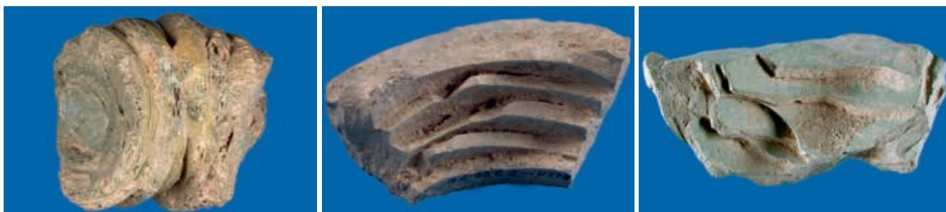
Abb. 2: Beispiele für Fehlbrände.
