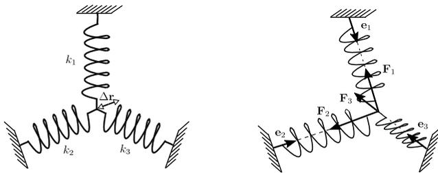
**Bild 1.2** Steifigkeitstensor eines Federsystems
