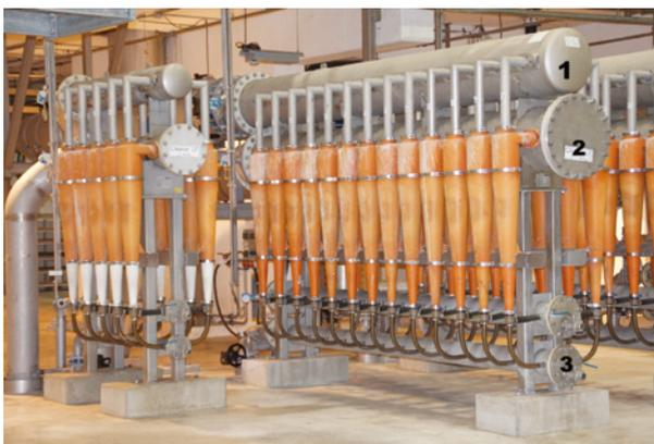
**Bild 3.21** Kanisteraufbau einer Cleanieranlage für eine Papiermaschine für Wellpappenrohre (Quelle: H.-J. Naujock)
