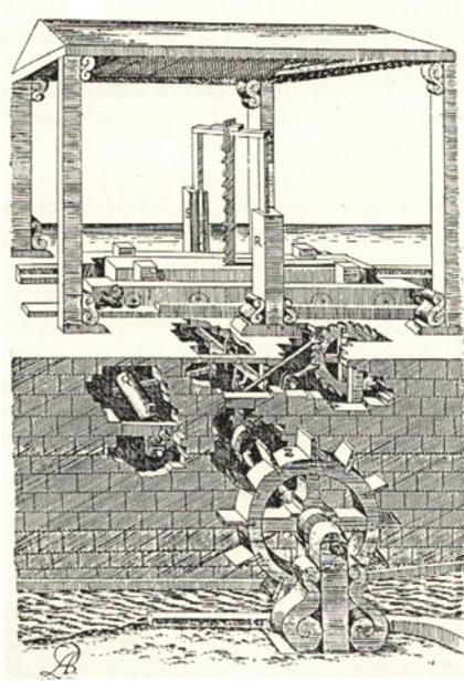
**Bild 2.2** Mit Wasserkraft angetriebene Werkzeugmaschinen wurden im 16. und 17. Jahrhundert immer ausgefeilter. In der Abbildung ist eine Gattersäge zum Schneiden von Dielen und Brettern aus dem Jahr 1620 zu sehen. Das Wasserrad treibt nicht nur die Hubbewegung des Sägeblattes, sondern auch den Vorschub des zu bearbeitenden Holzstückes (Bildquelle: Paturi et al. 1997).
