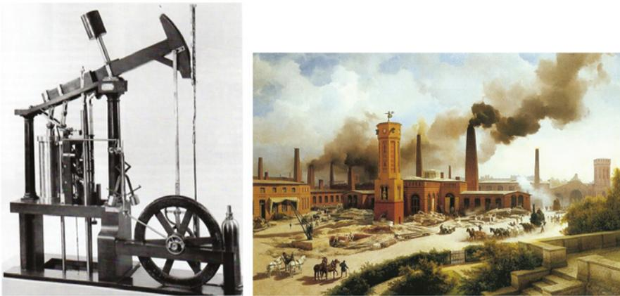
**Bild 2.3** Industrialisierung: Watt'sche Dampfmaschine als doppelt wirkende Niederdruckmaschine mit Schwungrad (links) und Fabrik zur Fertigung von Lokomotiven (rechts); Bildquellen: Paturi et al. 1997 (links) und [https://www.kinderzeitmaschine.de/fileadmin/user\\_upload/Neuzeit/Nationalstaaten/industrialisierung\\_01.jpg](https://www.kinderzeitmaschine.de/fileadmin/user_upload/Neuzeit/Nationalstaaten/industrialisierung_01.jpg) (rechts).
