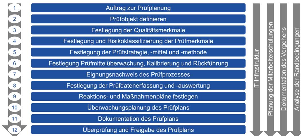
**Bild 3.2** Verfahren zur adaptiven Prüfplanung (vgl. [MUEL19])
