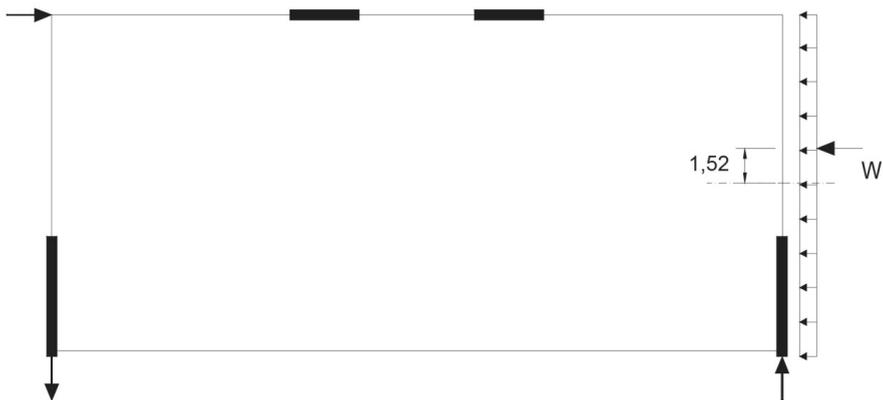
Abb. 2.17 Ansatz der resultierenden Windlasten
