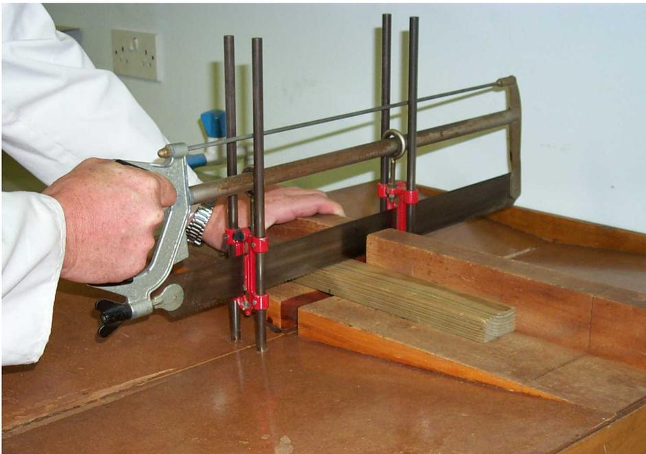
**Bild 6 — Modifizierte Gehrungssäge für die Herstellung einer Sägespanprobe**
