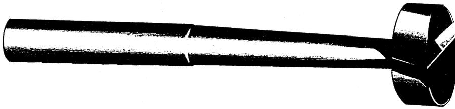
**Bild 5 — Ein Schneckenbohrer nach Forstner**
