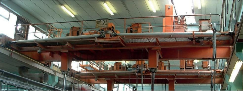
Abb. 2.10: Zweiträger-Brückenkrane mit Zentralantrieb „C“. Der Fahrtriebomotor ist in Bildmitte erkennbar.
