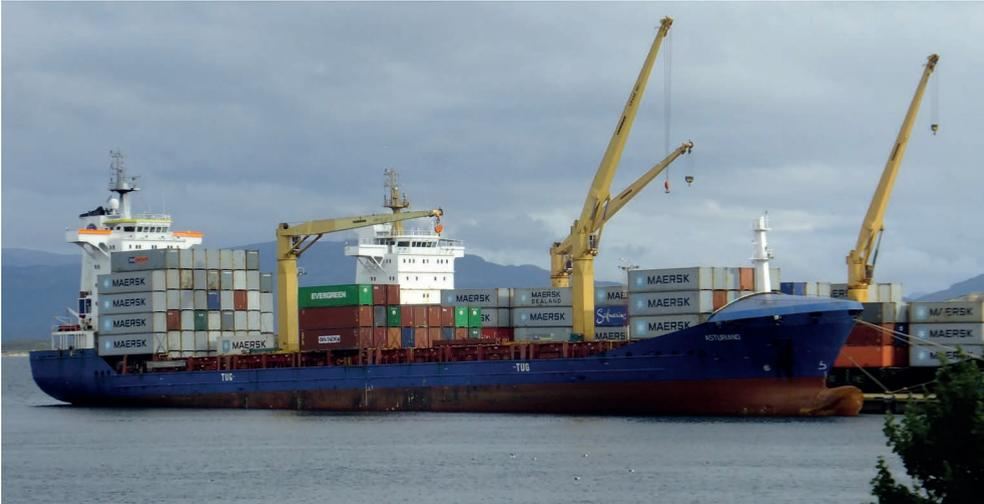
Abb. 1.17: Schiffskrane (Ushuaia, Argentinien, 2016)
