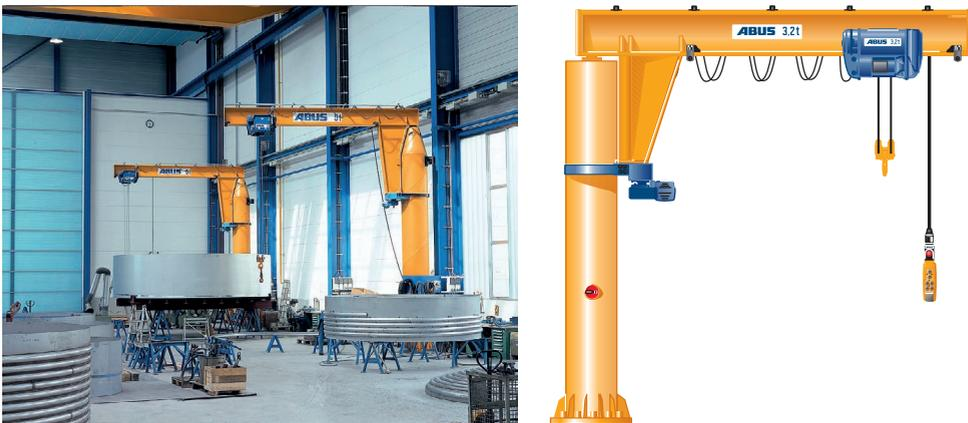
Abb. 1.7: Säulendrehkrane nach DIN EN 16851 (© ABUS Kransysteme GmbH)
