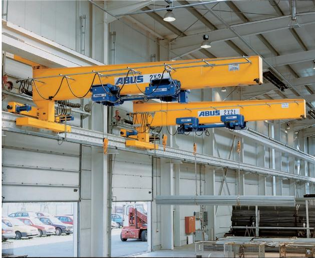
Abb. 1.15: Konsolkrane (© ABUS Kransysteme GmbH)
