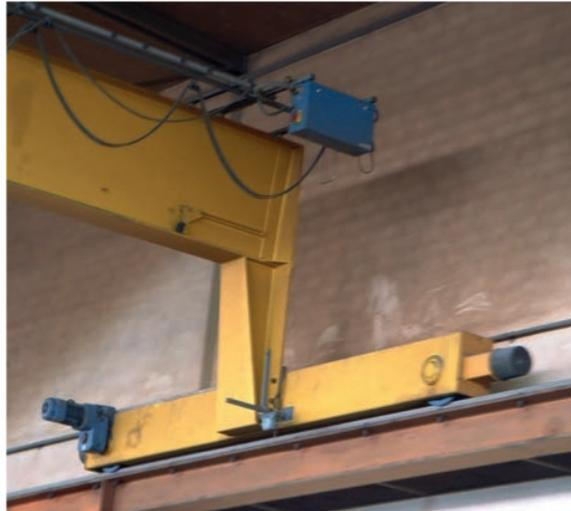
Abb. 2.9: Einträger-Brückenlaufkran mit Einzelradantrieb „I“ erkennbar an dem Fahrtriebsmotor am Kopfträger am linken Bildrand
