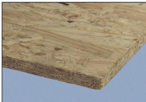
**Bild K.17 — Holzwerkstoffplatte, z. B. OSB-Platte**
