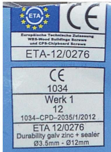
**Bild K.21 — CE-Kennzeichnung auf der Verpackung von bauaufsichtlich zugelassenen Schrauben (CE-Verwendbarkeitsnachweis)**
