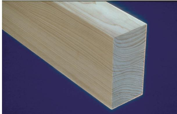
**Bild K.11 — Balkenschichtholz**
