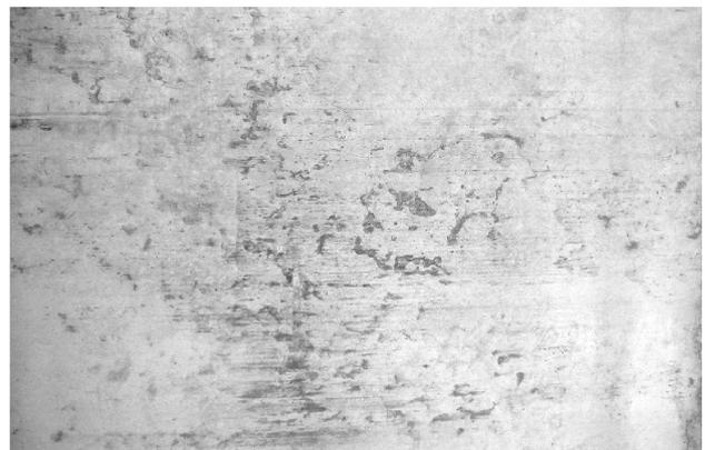
**Bild 1:** Korrosionserscheinungen an der Schaltschalenoberseite (links) und der Fertigteiloberfläche (rechts)
