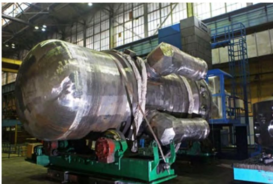
PHOTO 1.19 – La cuve d'un réacteur de la classe Arktika (photo Rosatom).
