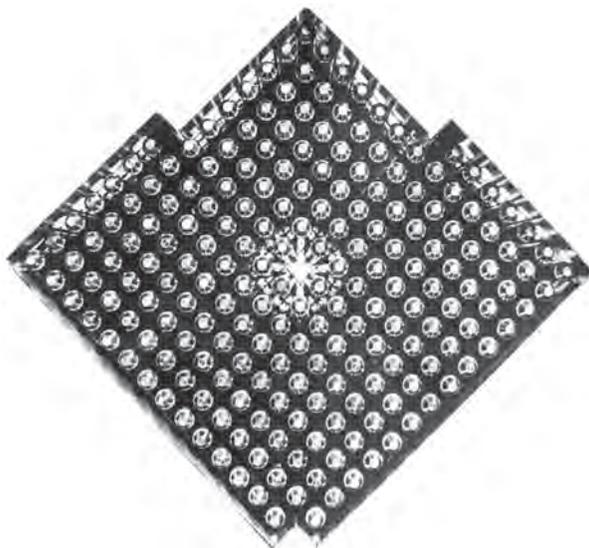
PHOTO 1.34 – Une vue de dessus d'un assemblage combustible. Les « découpes » des rangées de crayons supérieures permettent l'insertion des croix de contrôle [Sauteron, 1965].
