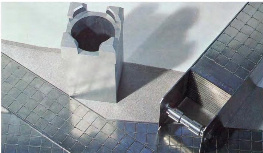
PHOTO 1.27 – Le combustible « Caramel » du réacteur Osiris (photo CEA). La pièce cylindrique en arrière-fond est le pied d'assemblage. Les pastilles parallélépipédiques d'oxyde d'uranium frittées sont isolées les unes des autres et disposées entre deux tôles de zircaloy. Cette disposition limite la contamination du primaire en cas de dégradation du combustible par rapport au concept de crayon cylindrique.
