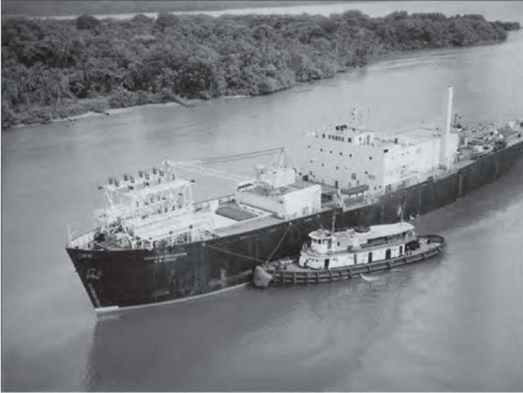
PHOTO 1.36 – Le *Sturgis* remonte une rivière avec l'aide d'un escorteur. On voit à l'avant du bateau le système de connexion électrique.
