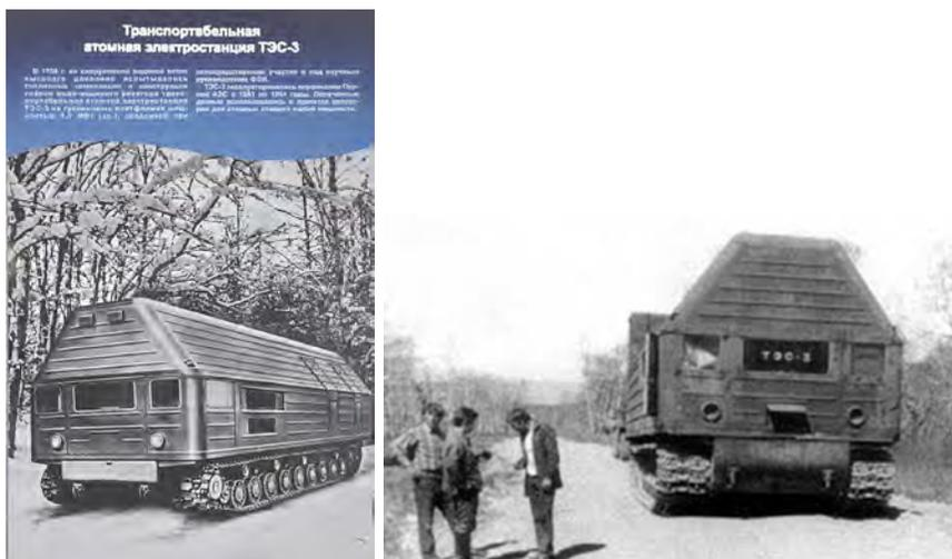
PHOTO 1.20 – Poster de présentation du *TES-3* du musée du nucléaire d’Obninsk. Monté sur un châssis de char à 9 essieux, le TES-3 a un poids supposé de 310 tonnes.
