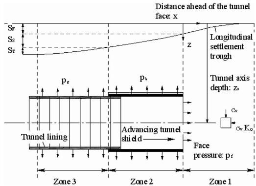
Figure 12. Definition of parameters (Wongsaroj et al.).
